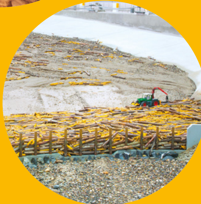
Der Schwemholzrechen stoppt das Holz. Bild: VAW, ETH Zürich
